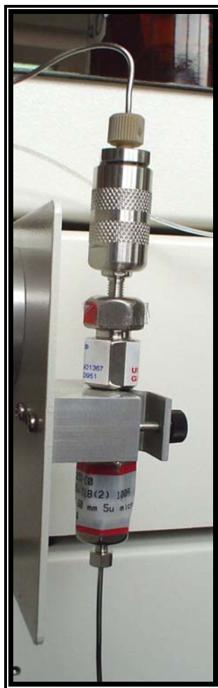
Figura No. 9. Columna de HPLC C 18 de 50 mm de long. x 4.6 mm de d.i., 5 µm de tamaño de partícula y 100 Å de porosidad, de marca Luna con guarda columna.
