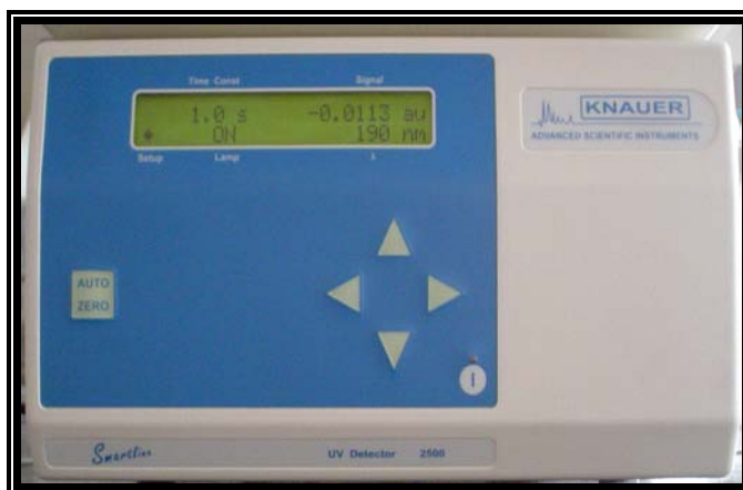
Figura No. 10. Detector Knaauer Smartline UV 2500 de longitud de onda variable.
