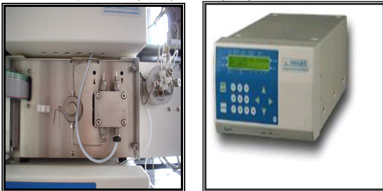
Figura No. 7. Bomba Smartline 1000 Knauer y cabezales de los pistones de la bomba.
