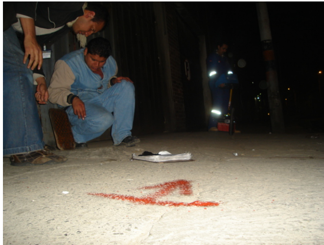
Figura 5.8 Inicio de levantamiento y trayectoria de resultado 2 con radar de penetración de suelo. La flecha naranja sirve como inicio y referencia. El inicio se encontraba a 7 metros del punto localizado por el correlacionador.
