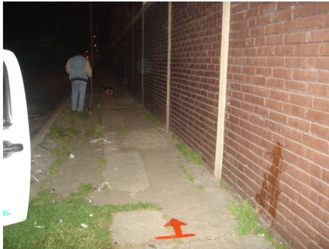
Figura 5.5 Inicio de levantamiento y trayectoria de resultado 1 con radar de penetración de suelo. La flecha naranja sirve como inicio y referencia. El inicio se encontraba a 8 metros del punto localizado por el correlacionador.
