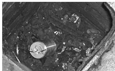
Figura 2.16 Colocación de sensor sobre vástago de válvula.
