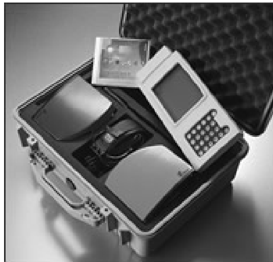
Figura 3.11 Sistema acústico de correlación en tiempo real. Se pueden observar la unidad de correlación y los radios (PRIMAYER 2005).
