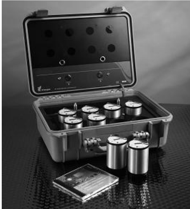
Figura 3.12 Sistema acústico de correlación de post-procesamiento. Se pueden observar los registradores y el maletín que sirve para programarlos y descargar la información a una computadora (PRIMAYER 2005).
