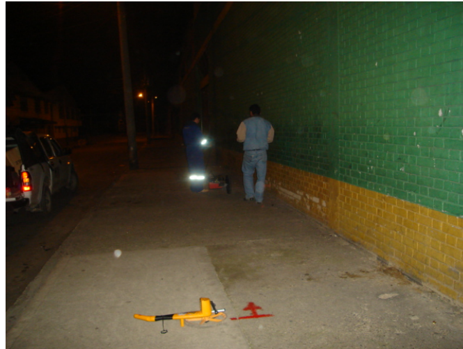
Figura 5.11 Inicio de levantamiento y trayectoria de resultado 2 con radar de penetración de suelo. La flecha naranja sirve como inicio y referencia. El inicio se encontraba a 5 metros del punto localizado por el correlacionador.
