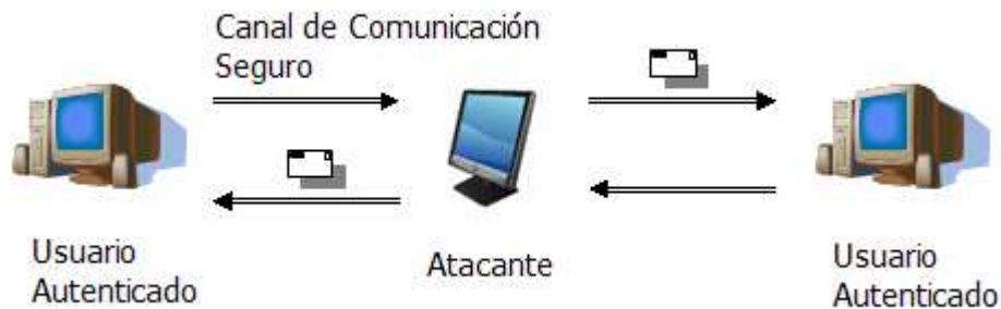
Figura 3.4 Esquematización de un ataque man in the middle
