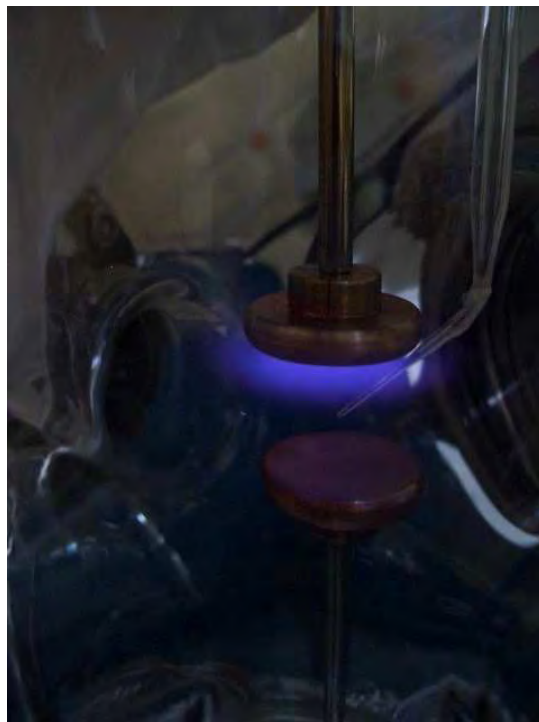
Figura 5.7: Descarga de Resplandor con la sonda de Langmuir
