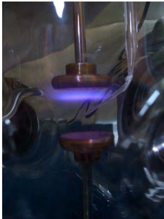
Figura 5.8: Descarga de resplandor con la sonda de Langmuir
