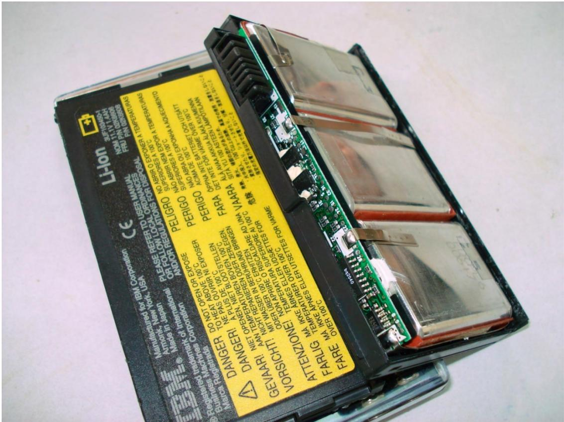
*Fig. 3.36. Batería Li/Ion empleadas en una computadora portátil*
