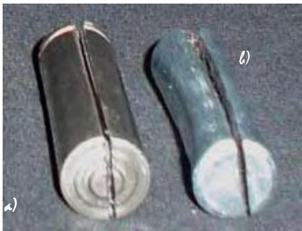
*Fig. 3. 35. Corte sobre el polo: a) Positivo Pila Alcalina; b) Negativo Pila Seca*
