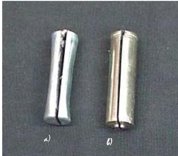
*Fig. 3.34. Corte longitudinal a lo largo de: a)Pila Seca; b)Pila Alcalina*
