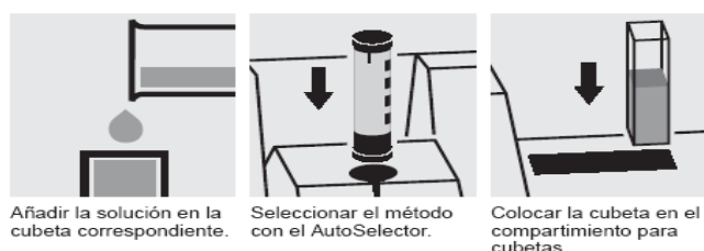
Figura B.1 Esquema de uso de la técnica de determinación de concentración de cobre.
