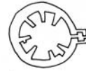
Planta de una casa "vuelta" en Gnetland: los muros de piedra y de tierra la dividen en compartimientos para diferentes familias o usos
