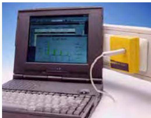
Figura 2.2 Registrador de eventos en contacto e interfaz.
