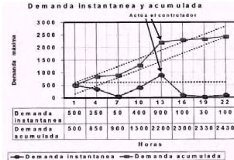
Figura 5.5 Método de la demanda acumulada vs instantánea.
