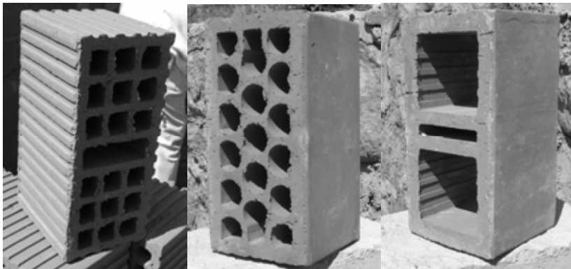
Fotografía 3. Diferentes tipos de tabique de barro comprimido.
