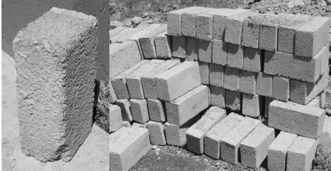
Fotografía 5. Tabicón de concreto vibro-compactado.
