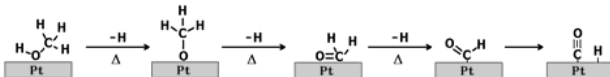
Figura 3. Posibles intermediarios formados a partir de la deshidrogenación de metanol adsorbido sobre la superficie de platino mediante el fragmento \text{-OH} en condiciones de alto vacío. Esquema adaptado de [17].
