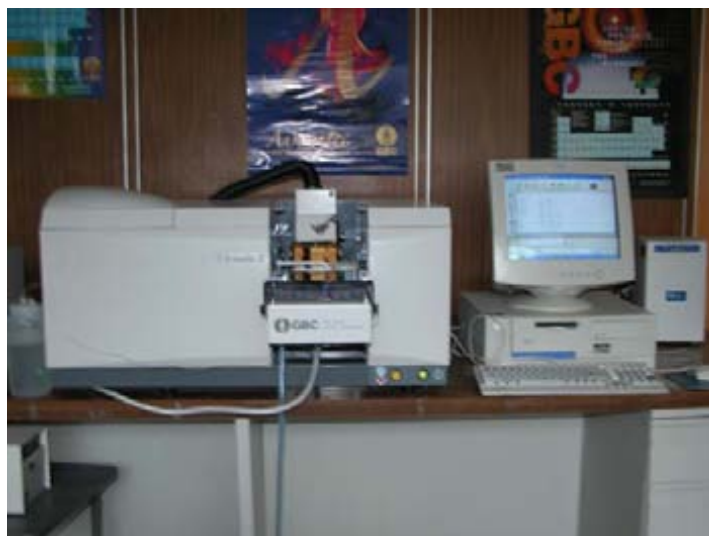
Figura 4.10 Espectrofotómetro de Absorción Atómica con Horno de Grafito AVANTA-GBC.
