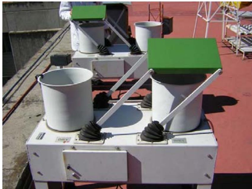
Figura 4.3: Colector automático de lluvia marca Andersen.
