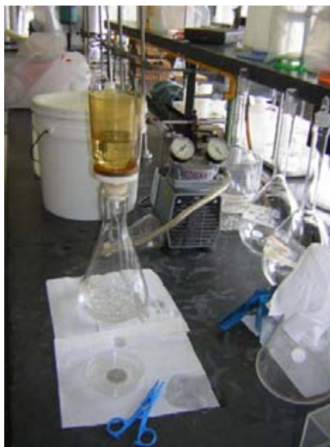
Figura 4.5. Filtrado de las muestras.
