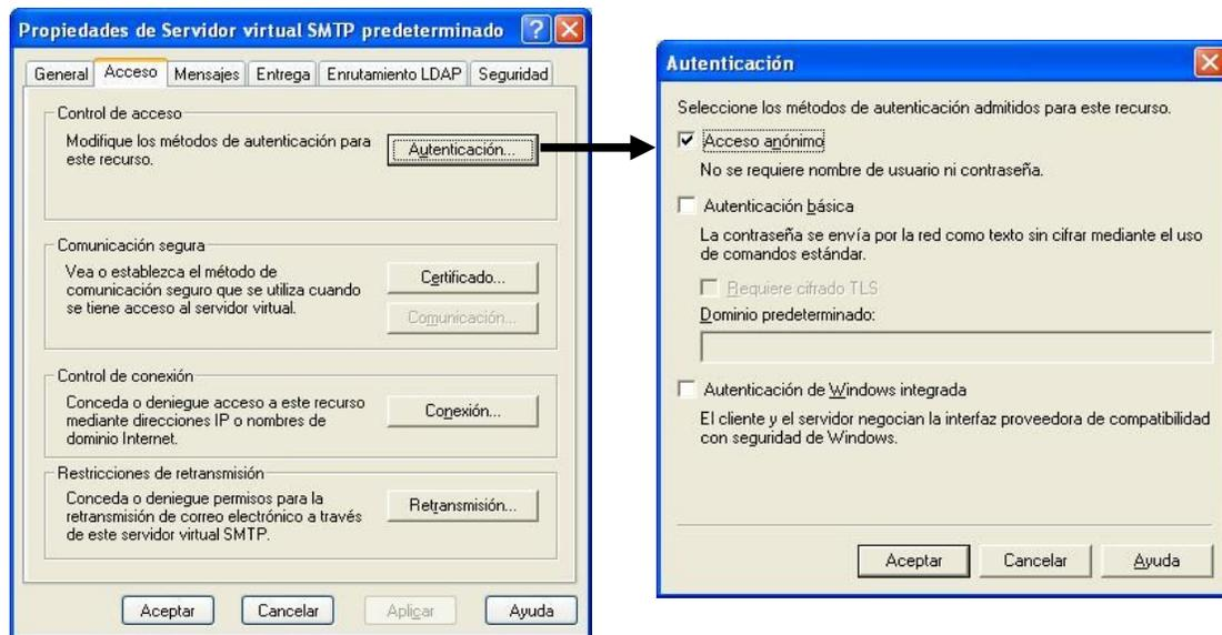
Figura 4.12 Pantalla de propiedades del Servidor virtual (Selección de método de Autenticación)
