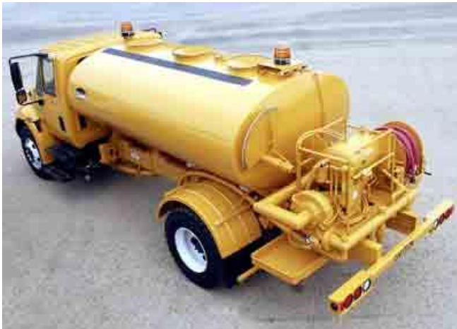
ESQUEMA DE UN DISTRIBUIDOR DE ASFALTO
