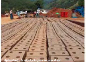
Apilamiento de adoblocks para secado al sol.
