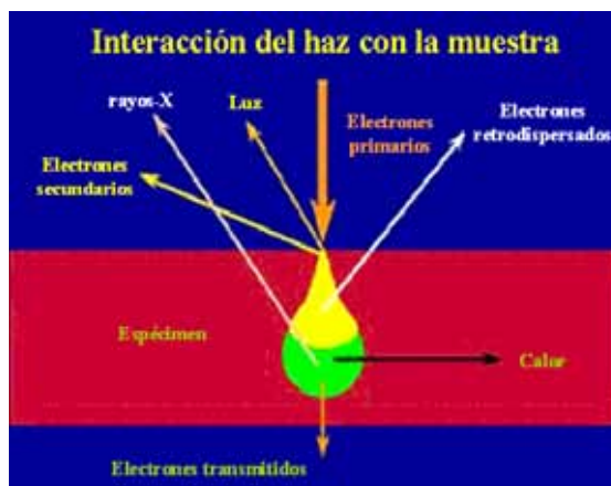
Figura XXII. Regiones de generación de señales dependientes de la profundidad en un sólido.
