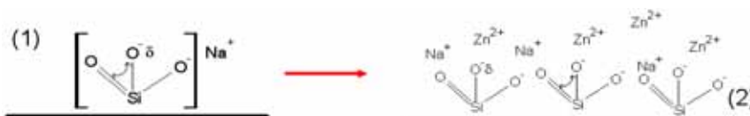
Figura LII. (1) Silicato de sodio presente en la zeolita y su interacción en el proceso de intercambio iónico.
