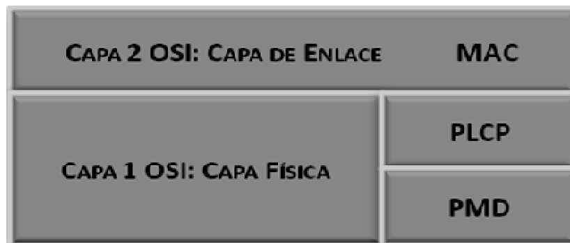
Figura 2.5 Capas Modelo OSI
