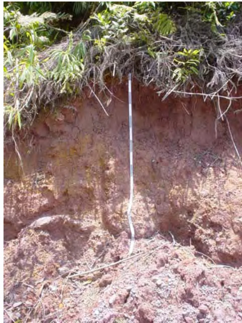
Figura 4.10 Suelos residuales en coluviones. a) Regosol en depósito de coluvión generado por un proceso gravitatorio de miles de metros cúbicos en las lluvias de 1999. b) Detalle del reciente suelo generado a partir de material coluvial antes mencionado. c) Estructura columnar en suelo coluvial con composición principalmente volcánica. d) Suelo coluvial en un depósito de flujo de lodo generado a partir de la movilidad de partículas finas de lutitas.
