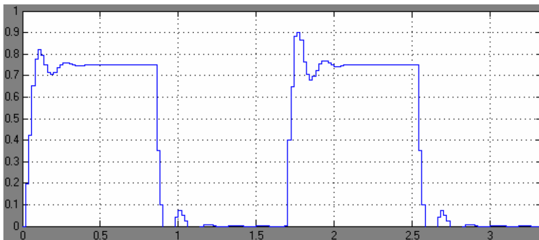
Fig. 4.12 Respuesta de Corriente (A) vs Tiempo (s) para K_I = 31.25 y K_P = 1.25
