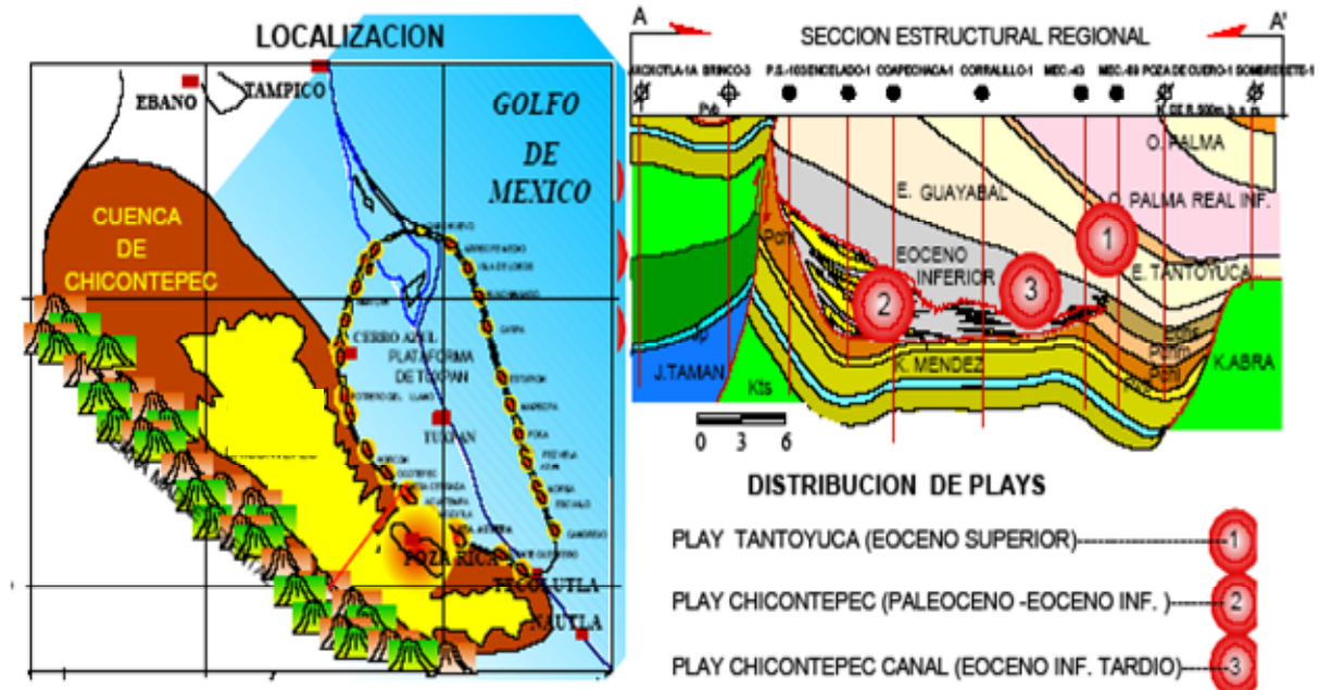
Fig. 3.11 Muestra la distribución del Cuenca de Chicontepec y una sección transversal en donde se muestra la ubicación de los tres plays productores 41
