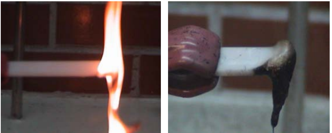
Figura 3.18 Evaluación de la rapidez de combustión del HIPS.
