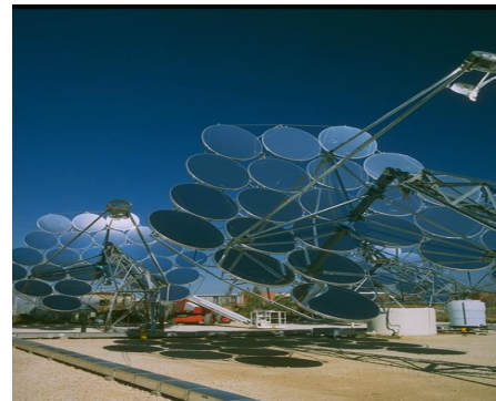
Figura 44 Platos parabólicos para captación de energía solar
