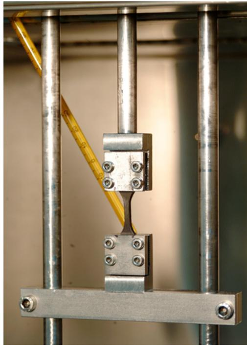
Figura 3.4. Detalle de las mordazas y el travesaño interno con el montaje de una probeta de polietileno.
