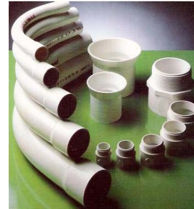
TUBERIAS Y ACCESORIOS SANITARIOS: tuberías específicamente para la recolección de aguas negras. línea ASTM, la línea norma DIN (milimétrica) y la tubería Tubotec,. El diámetro de estas tuberías va desde 2" ó 50mm hasta 6" en el caso de las tuberías ASTM y Tubotec y hasta 250mm para la milimétrica.
