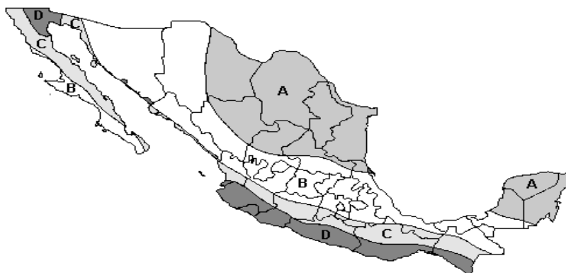
Figura 1.3. Regionalización sísmica de México, (SSN 1990)
