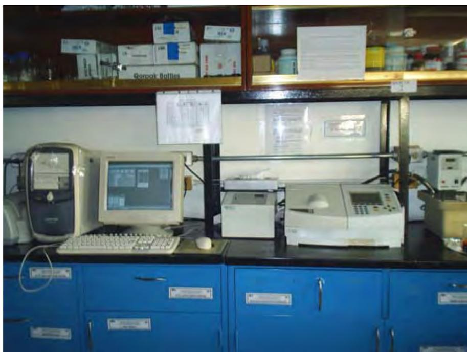
**Figura 11. Espectrofotómetro UV-VIS (Marca Thermospectronic modelo Helios  $\alpha$ ).**
