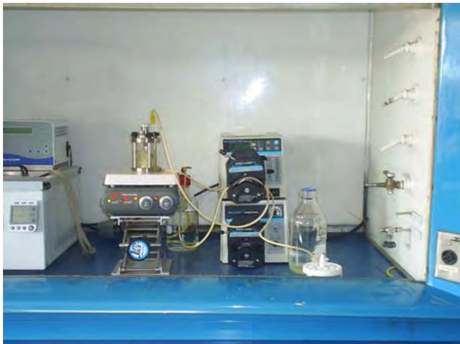
**Figura 12. Equipo para hidrólisis enzimática**
