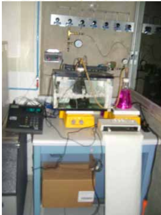
Figura 4.2. Reactor sulfato reductor para el desarrollo experimental
