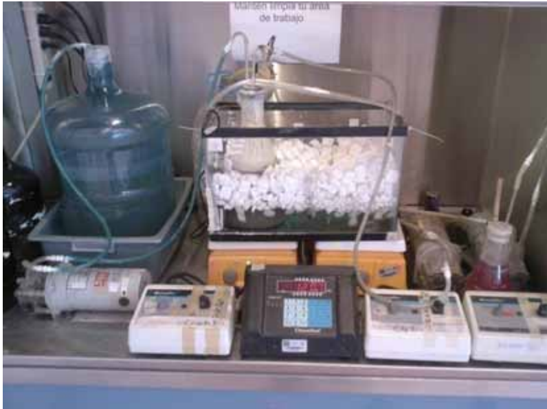
Figura 4.1. Reactor sulfato reductor para la aclimatación
