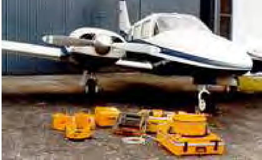
Avioneta cessna 402 bimotor con los electos para una prospección como son cámara fotográfica métrica mira de navegación magazines y navegador GPS
