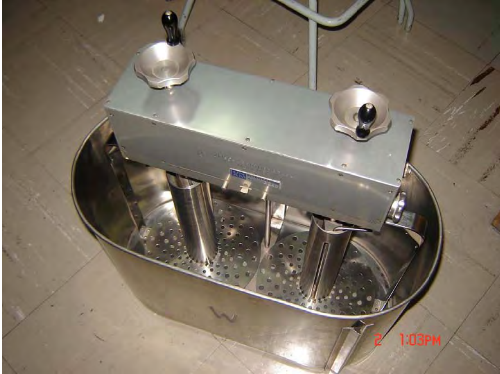
Tanque con los carretes con la película embobinada para su procesamiento
