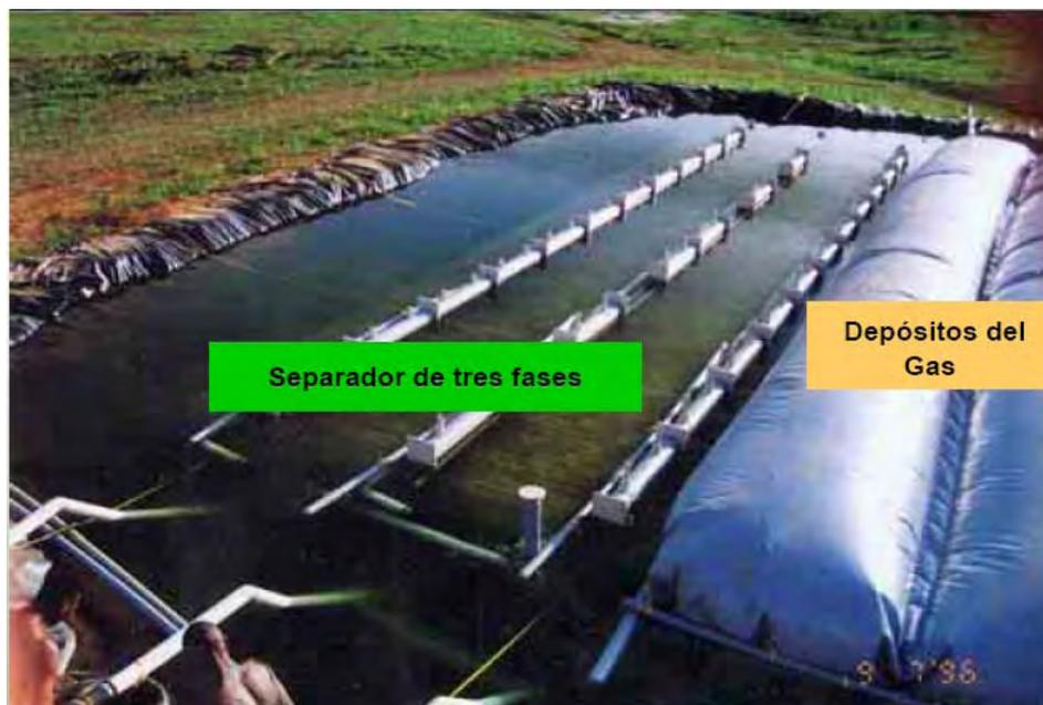
Fig. 3.5 Laguna de la Tecnología Biogás Nord usada en una destilería en Cuba.
