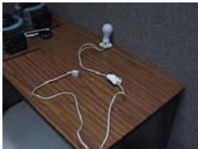
6.11 Cable con soquet, apagador y clavija
