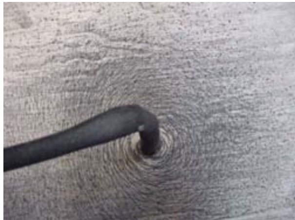
Figura 5.16 Campo magnético en una bobina y en una espira, generado por una corriente eléctrica.
