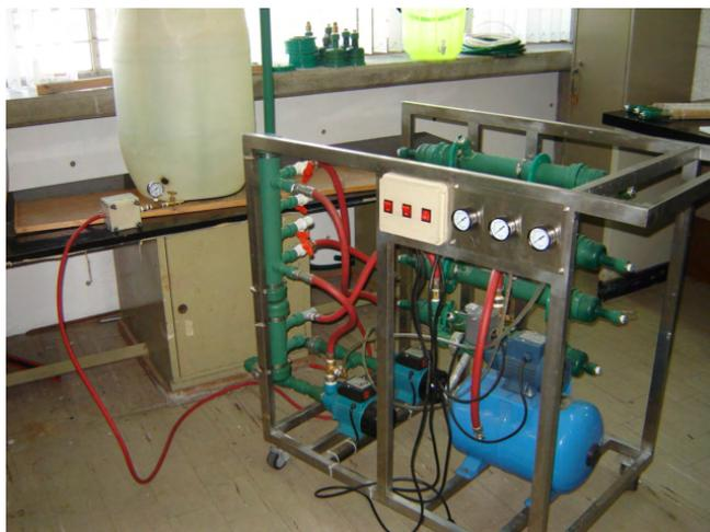
Figura 3.1. Unidad de laboratorio para ultrafiltración
