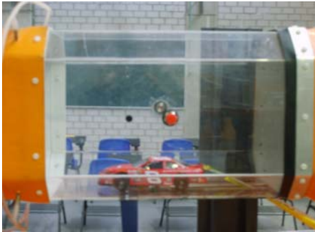
Fig. 3.7 Modelo fijado al piso del túnel
