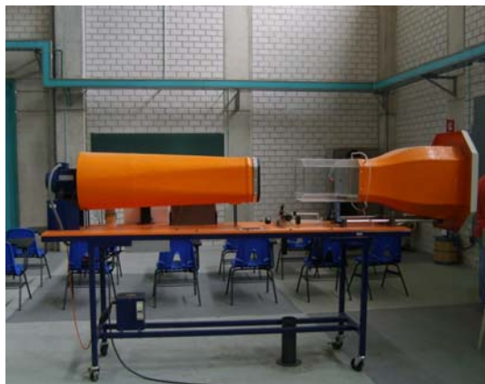
Fig. 3.3 Túnel Subsónico Armfield
