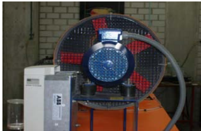
Fig. 2.8 Ventilador al final del túnel
