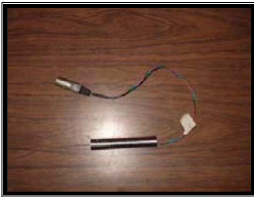
Fig. 4.2.2 DCDT empleado en el ensaye 1 del espécimen EF1
