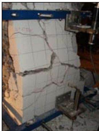
Fig. 1.8 Aspecto de la cara perpendicular a la dirección del actuador en el momento de la falla
