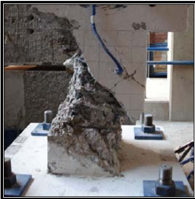
Fig. 5.3.1 Falla en el puntal diagonal BD del espécimen EF1
