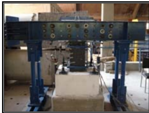
Fig. 3.5.4 Especimen reforzado con fibras de carbono
