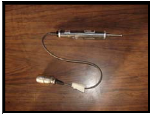
Fig. 4.2.3 DCDT empleado en el ensaye 2 espécimen EF1
