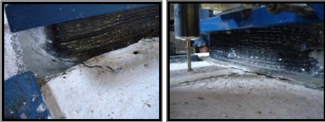
Fig. 4.4.2 Zonas con daños observadas en el espécimen ER1
