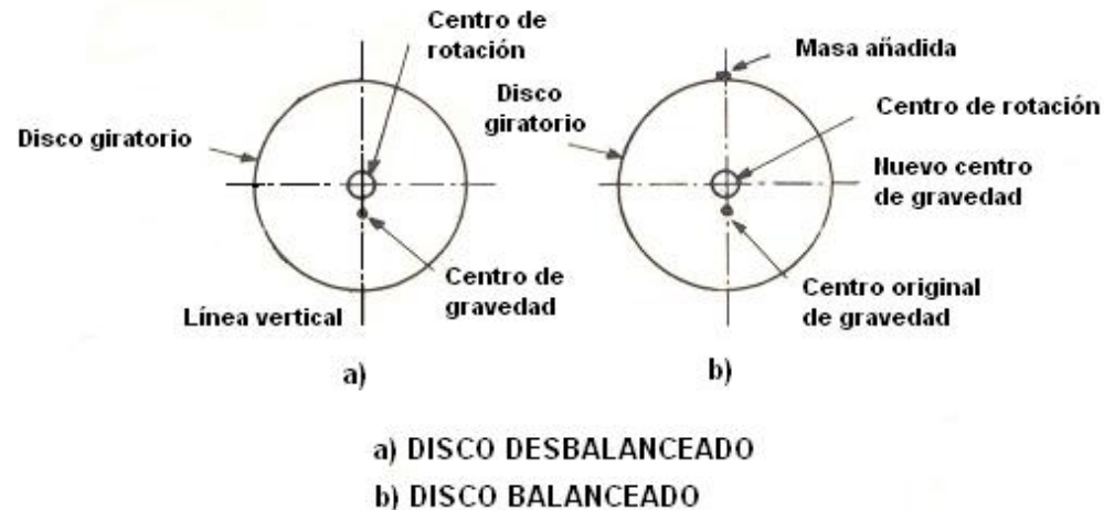
Figura N° 8. Procedimiento más simple de balanceo.
