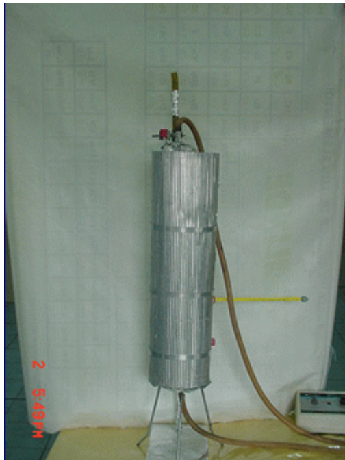
Figura 3.3. Reactores anaerobios para condiciones termofílicas (configuración parcial)
