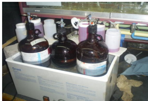
Figura 3.6. Configuración inicial del sistema intermitente de adaptación del lodo
