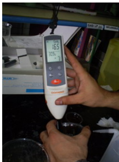
Figura 3.2. Metodología de medición de conductividad eléctrica
