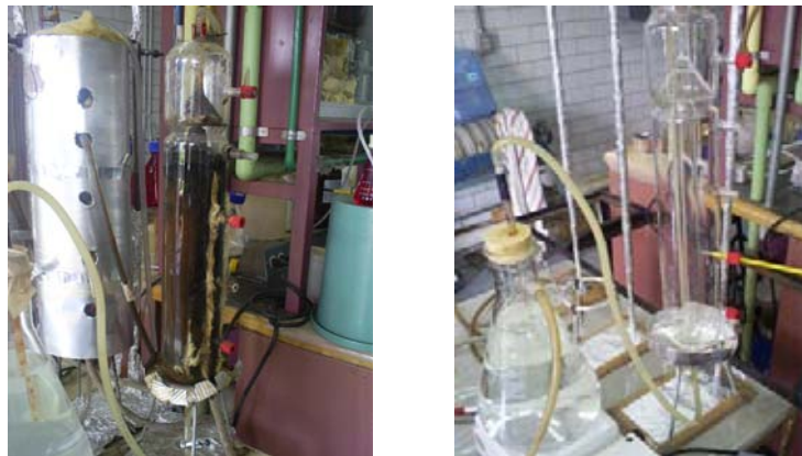
Figura 3.8 Reactores en proceso de limpieza e inoculación
