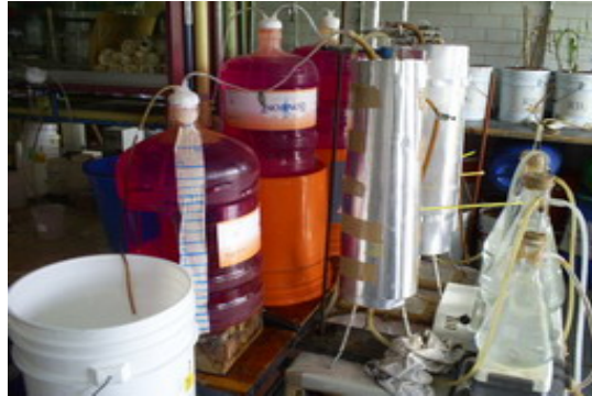
Figura 3.9 Sistema de medición de metano por Mariotte
