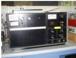
Figura 3.11 Cromatógrafo de gases Fisher Gas Partitioner Model 1200
