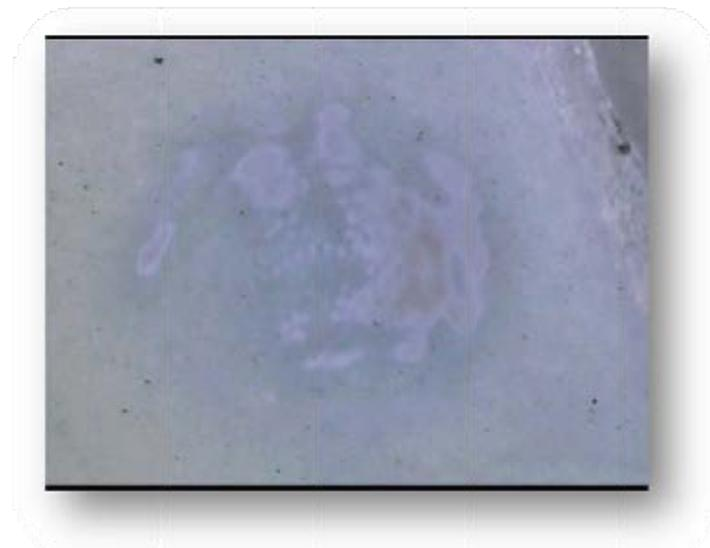
Figura 9. Fotografía del área irradiada, que muestra la no uniformidad del haz láser para la muestra S1.
