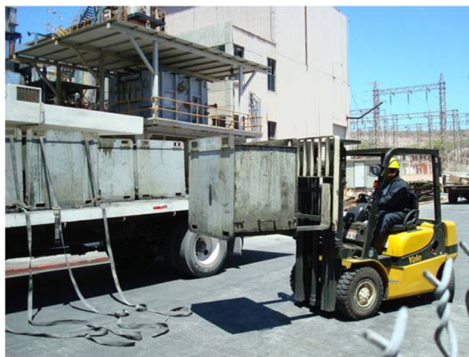
Fotografía 2. Maniobra para subir los contenedores con ceniza al camión que los llevará al sitio de confinamiento controlado
