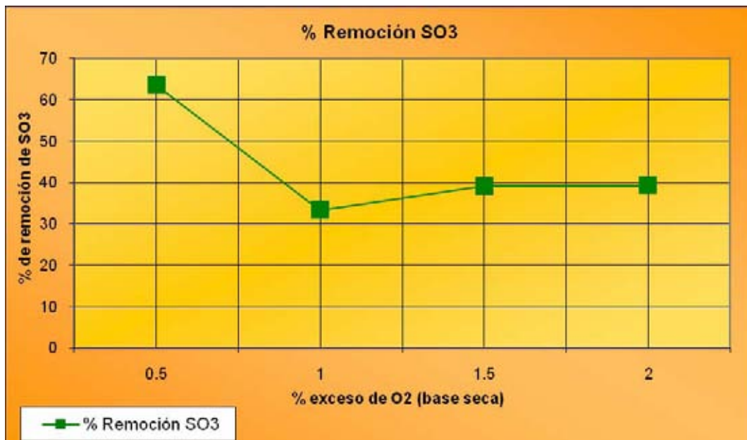
Figura 4.2. Porcentajes de remoción de SO 3 en los gases de combustión obtenidos por la adición del aditivo a base de Mg(OH) 2 en los mismos
