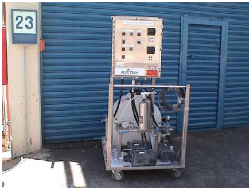
Figura 3.2. Planta piloto para dosificación del aditivo
