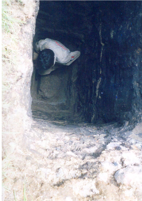
TRABAJOS DE EXPLORACIÓN POR MEDIO DE POZOS A CIELO ABIERTO
