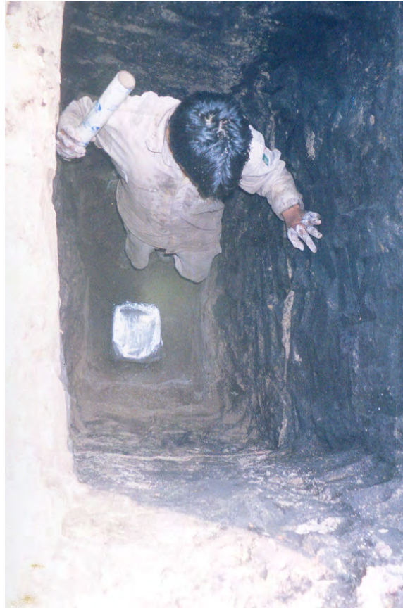
RECUPERACIÓN DE MUESTRAS CÚBICAS INALTERADAS EN EL POZO A CIELO ABIERTO
