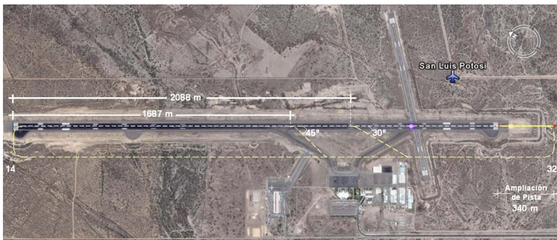
Figura 4.8 Distancia Real Geométrica 2ª salida desde el Umbral hasta Punto de Inflexión (PI)
