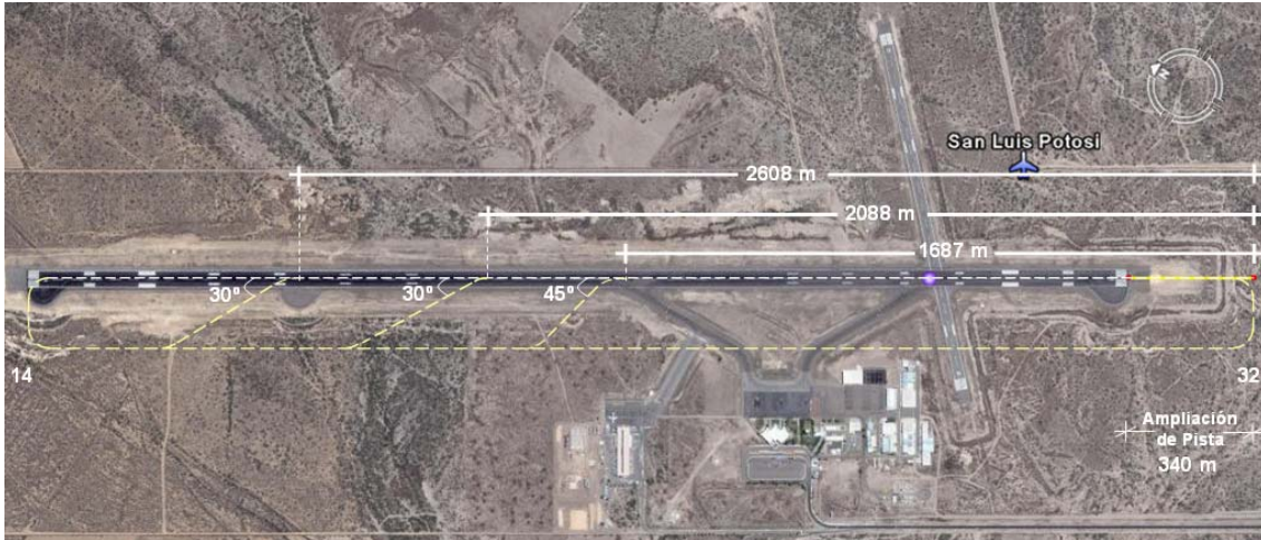
Figura 4.10 Distancias Reales Geométricas desde el Umbral hasta Punto de Inflexión (PI)
