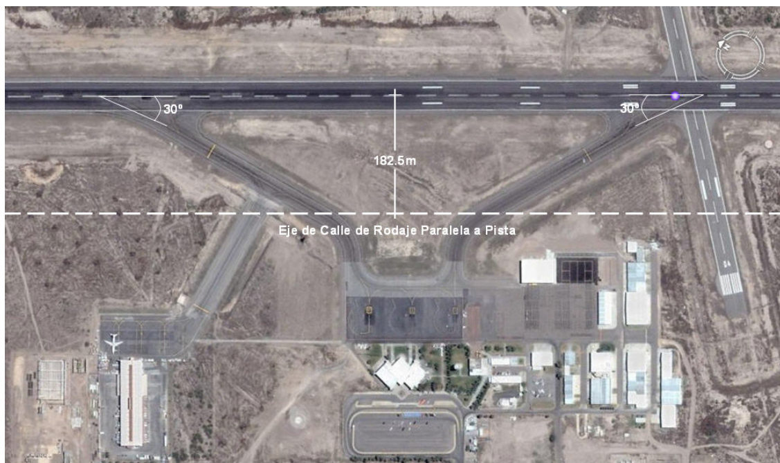
Figura 4.3 Distancia entre ejes recomendada en el anexo 14
