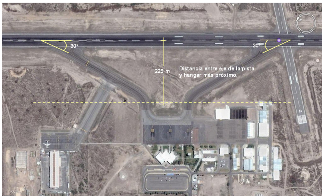
Figura 4.2 Distancia entre eje de pista y objeto más próximo
