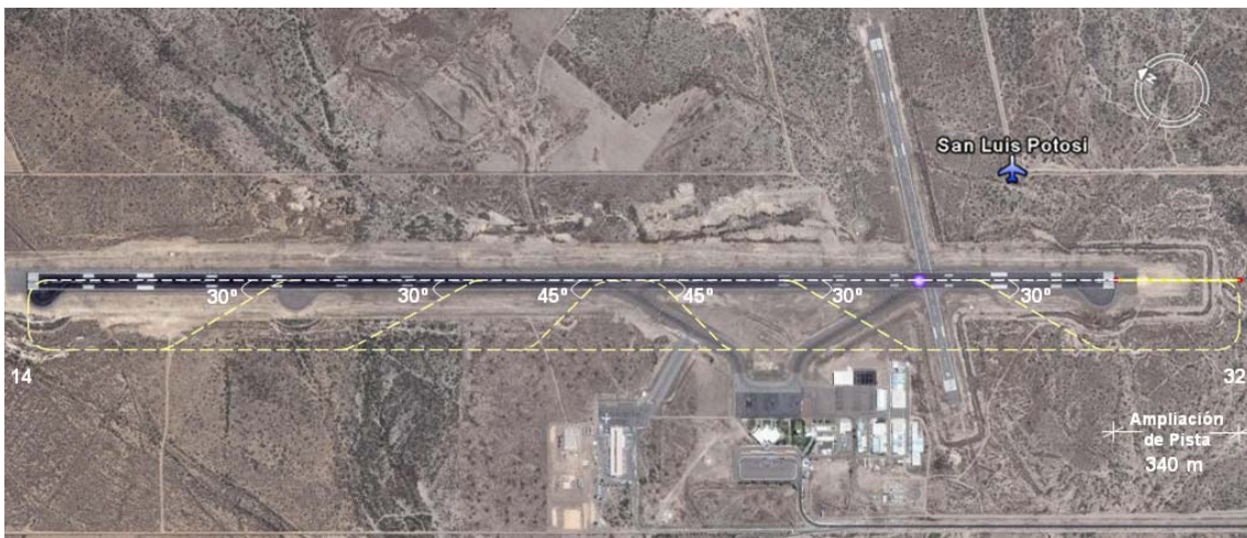
Figura 4.11 Salidas a 45 y 30 grados
