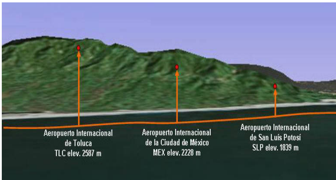
Figura 2.2 Comparación de elevaciones entre aeropuertos
