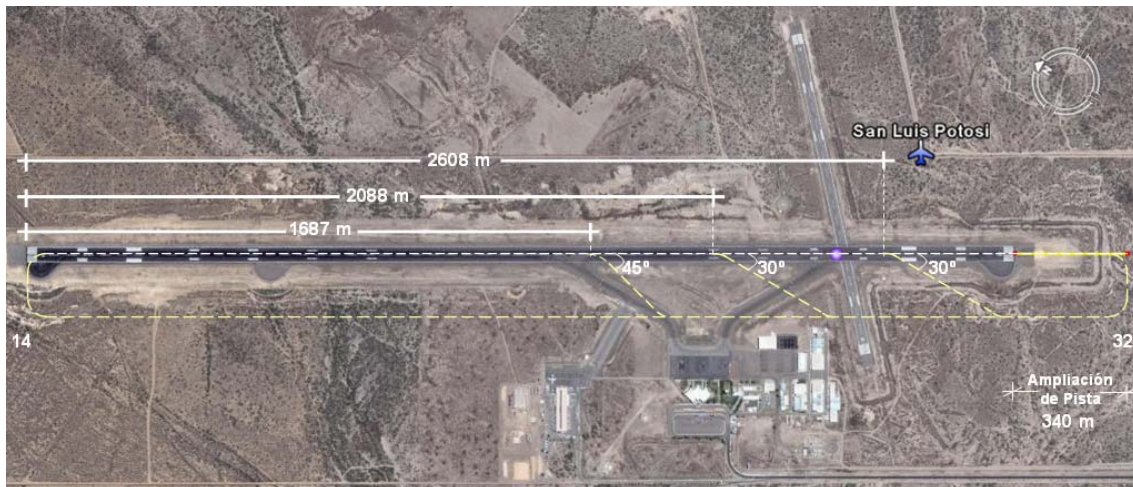
Figura 4.9 Distancia Real Geométrica 3 er salida desde el Umbral hasta Punto de Inflexión (PI)
