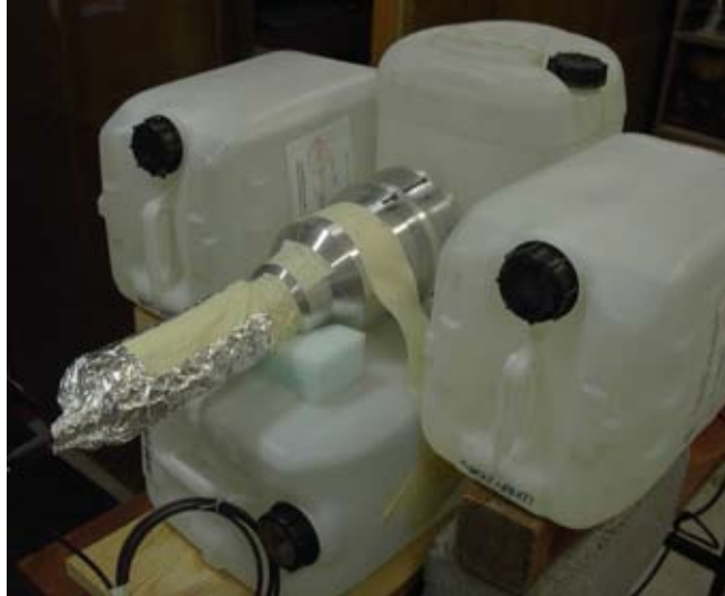
Figura 4.5: Sistema centellador-fotomultiplicador rodeado de garraones con agua posicionado tras la pared de concreto que separa la cámara de reacción del cuarto de control y adquisición de datos.
