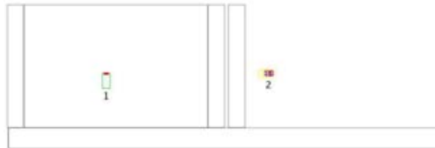
Figura 5.5: Vista desde “lado” de la ubicación de los componentes de la simulación, donde se observa la cámara de reacción (1) y los centelladores a 5 m (2).
