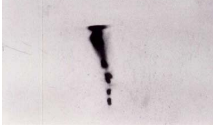
Figura 4.1: Destrucción de la columna de plasma debido a una inestabilidad “m=0”. Imagen de rayos X tomada del FN-II por medio de una cámara de agujero a través de un filtro de 5 \mu\text{m} de aluminio.
