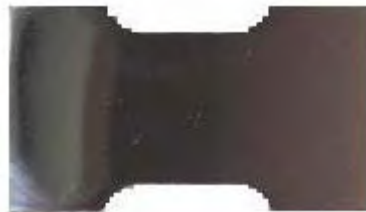
Figura 2.8. Probeta pulida a espejo, desengrasada y lista para montarla en la celda electroquímica.
