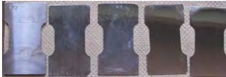
Figura 2.4. Acabado superficial de las probetas que vienen del proceso de maquinado, se muestra el acabado inicial hasta pulido a espejo.
