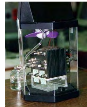
Celda de combustible bb. C-119
