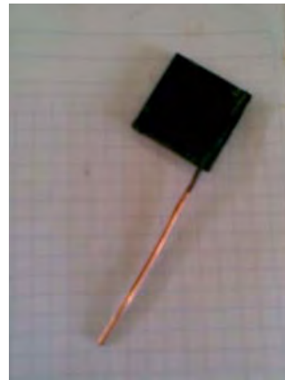
Figura 69. Electrodo de cobre con depósito de selenio
