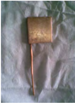
Figura 68. Electrodo de cobre limpio
