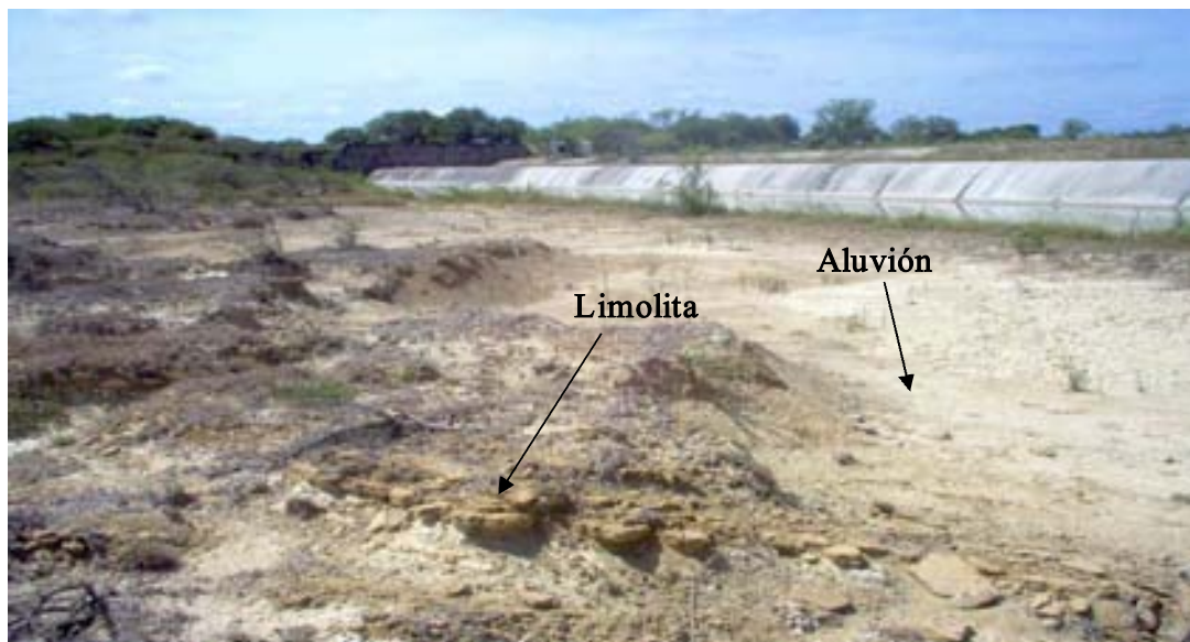
Fotografía 7.1.6. Se muestra la limolita por debajo del material aluvial, en la fotografía el material muestra un color café más oscuro que el material aluvial.
