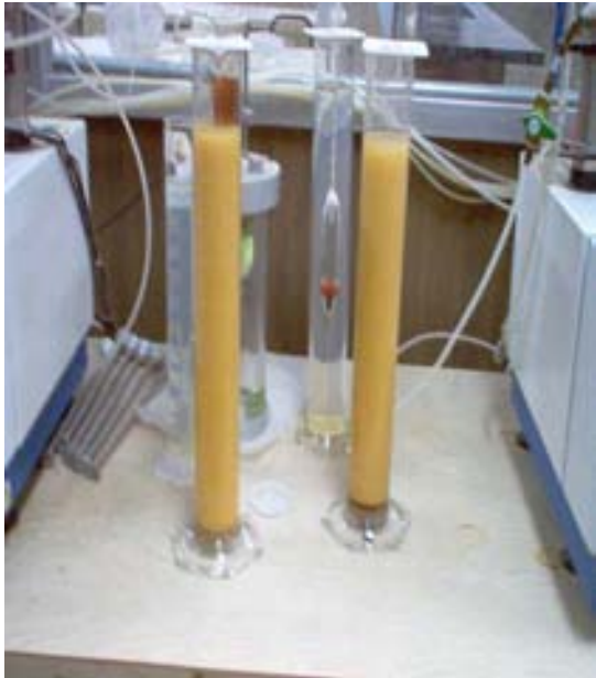
Fotografías 7.2.6. Y 7.2.7. Se muestra el material ensayado en laboratorio por medio del método de doble hidrómetro.
