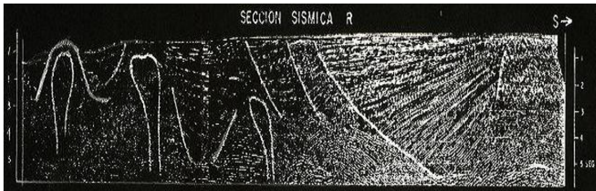
Figura. 6. 3. 4. A Secciones sísmicas P, Q, R, localizadas al norte frente a la ciudad de Coatzacoalcos, Ver., orientadas NW-SE, que muestran la prolongación hacia el mar de la Cuenca Salina del Istmo, caracterizada por una secuencia arcillo-arenosa del Terciario-Medio-Superior-Reciente intrusionada por diaporos salinos, por su efecto conforman una serie de arqueamientos anticlinales de forma cóncavas, separados por fallas lítricas.
