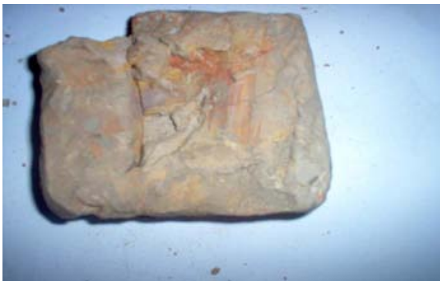
Fotografía 7.2.5. Esta fotografía muestra el suelo arcilloso que fue ensayado para saber el tipo de minerales de arcilla y el contenido de sales.
