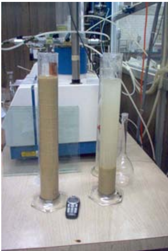
Fotografías 7.1.13. y 7.1.14 Se muestran dos ensayos del material realizados en el laboratorio empleando el método de doble hidrómetro.
