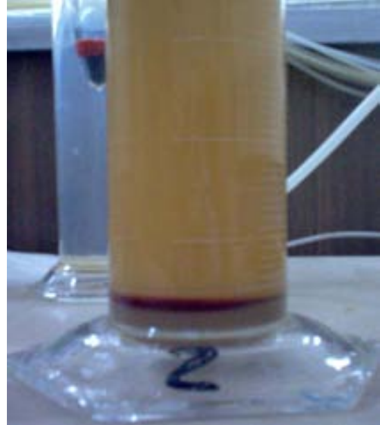
Fotografías 7.2.6. Y 7.2.7. Se muestra el material ensayado en laboratorio por medio del método de doble hidrómetro.
