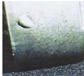
Figura 3.13 Ampollas por gas [1].
