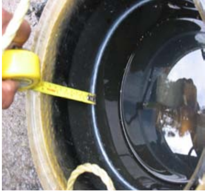
Figura 4-12. Cuantificación del grosor de la nata en el digestor UASB
