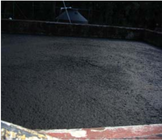
Figura 5-23. Apariencia de la nata formada 8 horas después de que fue precipitada
