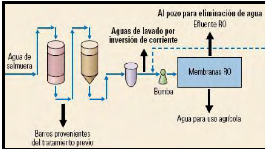
Fig. 3.3 Proceso para la eliminación de sales y contaminantes del agua producida.
