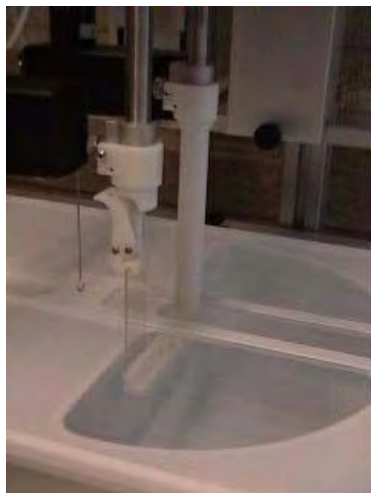
Figura III-5. Formación y secado de la película Langmuir-Blodgett.
