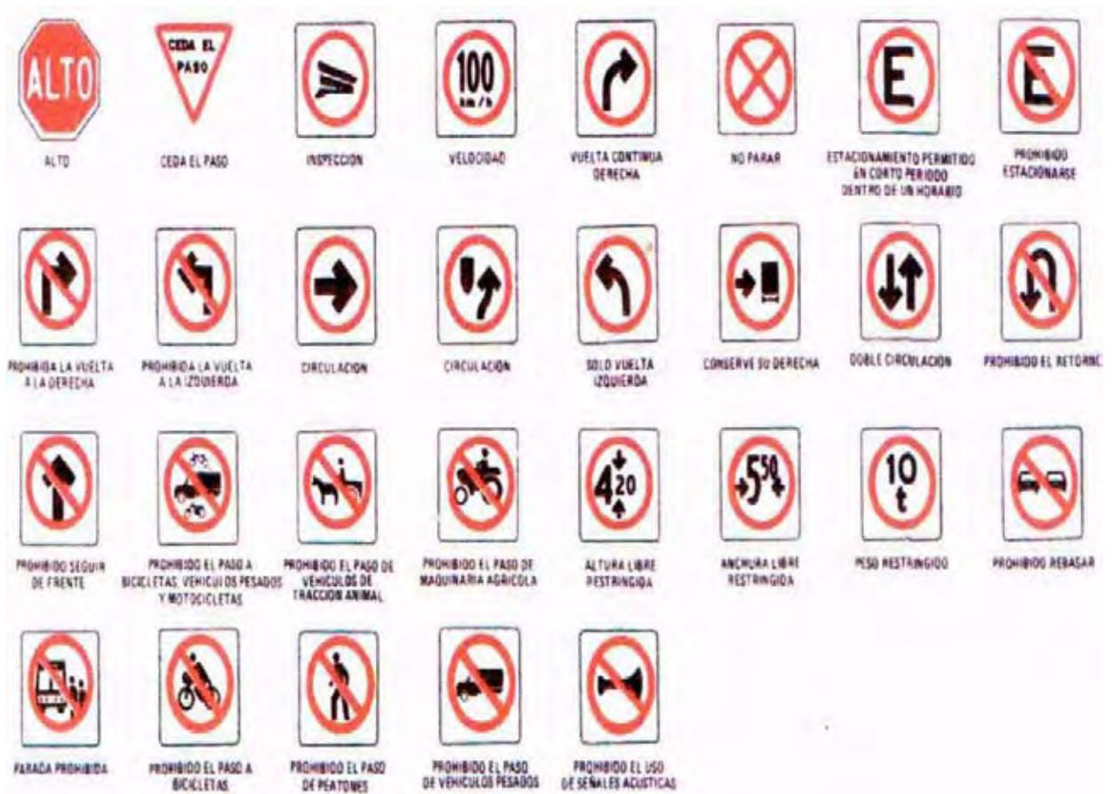
Figura. 2.9.4. Distintos tipos de señalamiento restrictivo.
