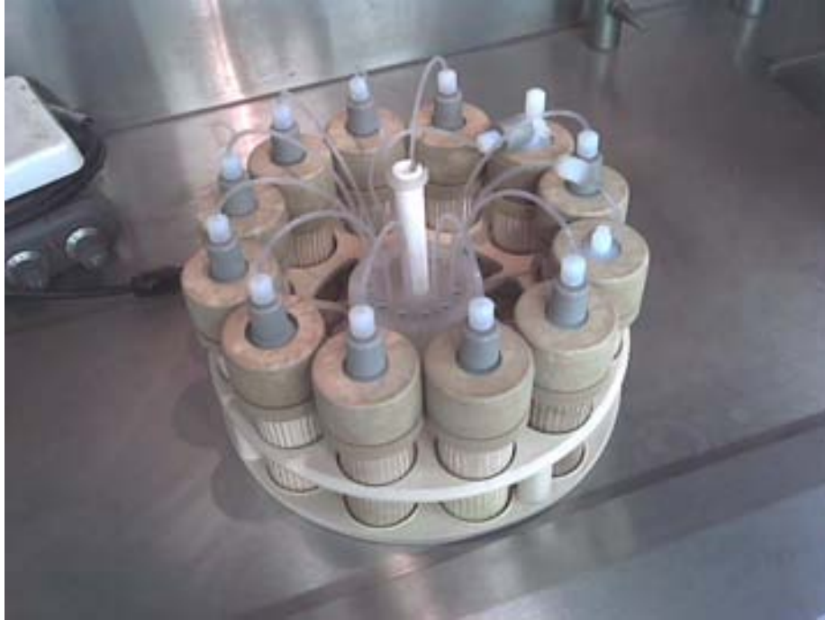
Figura 5. Los contenedores en la charola que se introdujo al horno de microondas.
