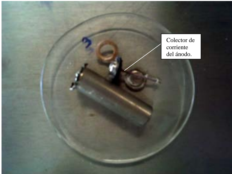
Figura 8. Componentes internos de una pila alcalina
