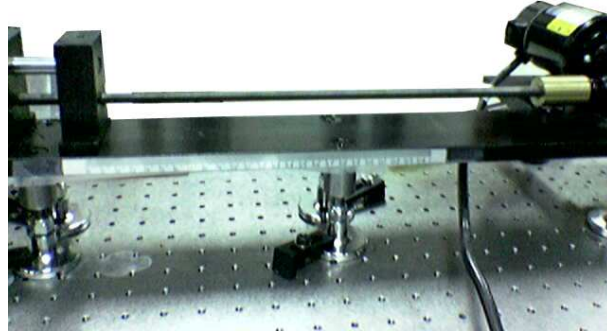
Figura 2.7: Acercamiento hacia el tornillo sin-fin por el que se mueve el carro guía del mecanismo
